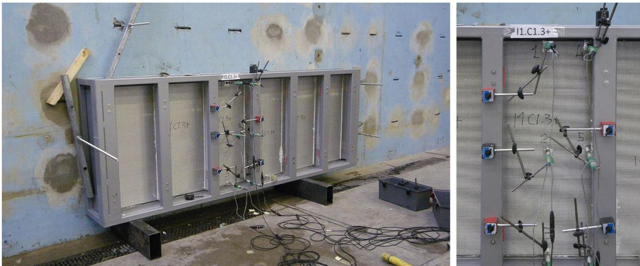
Для каждой плиты, которая подвергалась нагрузке, деформации были выявлены при помощи специального оборудования. Для получения значений устойчивости к ветровой нагрузке, пожалуйста, обращайтесь к Project Management Laminam SpA по адресу : [infobim@laminam.it](mailto:infobim@laminam.it)
